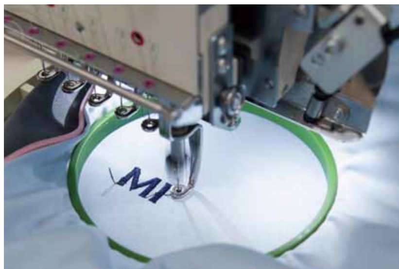
企業のロゴや個人の名前が、またたく間に自動刺繍されていく
